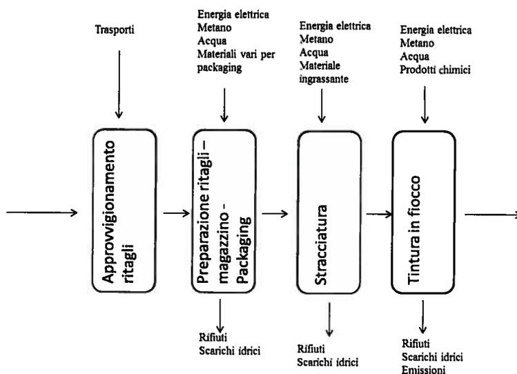
**Figura 2. Schema semplificato del processo di produzione della lana meccanica.**
